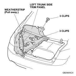
7. If equipped, remove the trunk panel (ten clips).
