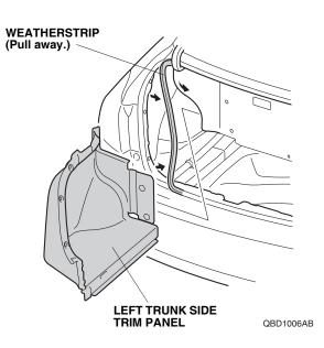
8. If equipped, remove the trunk panel (ten clips).
